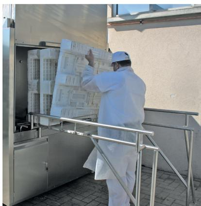
Per agevolare il carico / scarico di cassoni e bancali, è possibile equipaggiare la macchina di un tavolo di supporto esterno che facilita la movimentazione del materiale.
